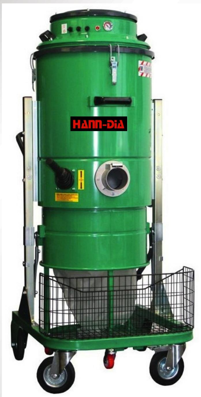
Der Sauger wurde speziell für die Aufnahme von großen Mengen Feinstaub in kürzester Zeit entwickelt und verfügt über drei einzeln zuschaltbare 1150-Watt Bypass-Saugmotoren in einem robusten Metallgehäuse. Ein Unterdruckanzeiger erlaubt die kontinuierliche Kontrolle des einwandfreien Betriebs und der möglichen Filterbelegung. Ein Warnlicht zeigt eventuelle Filterprobleme Filterkammer
