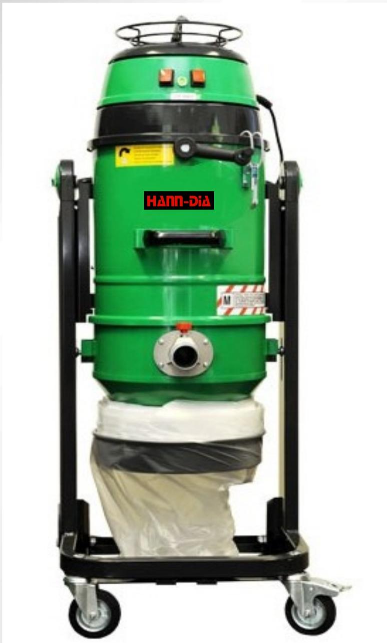
Der Sauger wurde speziell für die Aufnahme von großen Mengen Feinstaub in kürzester Zeit entwickelt und verfügt über zwei einzeln zuschaltbare 1150-Watt Bypass-Saugmotoren in einem robusten Metallgehäuse. Ein Unterdruckanzeiger erlaubt die kontinuierliche Kontrolle des einwandfreien Betriebs und der möglichen Filterbelegung. Ein Warnlicht zeigt eventuelle Filterprobleme
